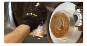
Die Bremsscheibenoberfläche reinigen. Benutzen Sie einen Bremsenreiniger.
