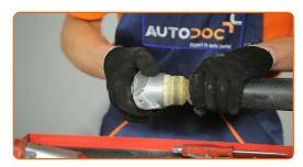
Schrauben Sie die untere Befestigung der Federbeinkolbenstange an. Verwenden Sie Stecknuss Nr. 16. Verwenden Sie einen Drehmomentschlüssel. Ziehen Sie ihn mit 25 Nm Drehmoment fest.
