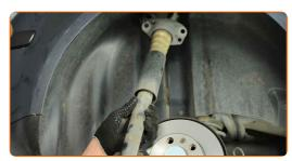
Schrauben Sie das obere Befestigungselement des Stoßdämpfers ab. Verwenden Sie Stecknuss Nr. 16. Verwenden Sie einen Ratschenschlüssel.
