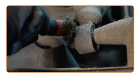
Schrauben Sie den unteren Befestiger des Stoßdämpfers ab. Verwenden Sie Ring-Gabelschlüssel Nr. 16. Verwenden Sie Stecknuss Nr. 16. Verwenden Sie einen Ratschenschlüssel.
