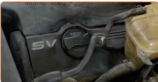
**26** Befestigen Sie den Deckel des Öleinfüllstutzens.
