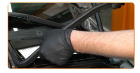
7 Entfernen Sie das Luftfiltergehäuse.
