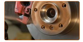
Die Bremsscheibenoberfläche reinigen. Benutzen Sie einen Bremsenreiniger.
