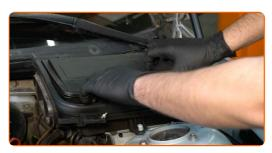
5 Entfernen Sie den Gehäusedeckel des Innenraumfilters.
