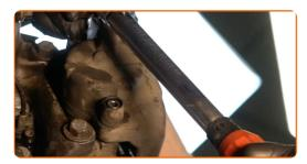
Installieren Sie die Staubschutzkappen der Bremssattel-Führungsstifte.
