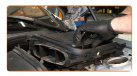
Befestigen Sie die Clips der Innenraumfilterabdeckung.
