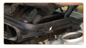
Bringen Sie das Luftkanal-Gehäuse an.
