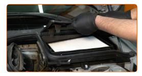
6 Entfernen Sie die Abdichtung des Mikrofilterkastens.
