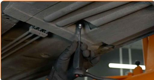
7 Entfernen Sie die Clips der unteren Außenabdeckung. Verwenden Sie einen Lösehebel, um die Clips zu entfernen.
