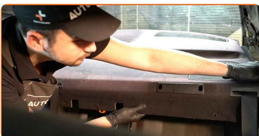
**9** Schraube die Befestigungen der Lautsprecher ab. Verwenden Sie einen Kreuzschlitzschraubendreher.
