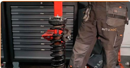
**56** Entfernen Sie das zusammengebaute Federbein.
