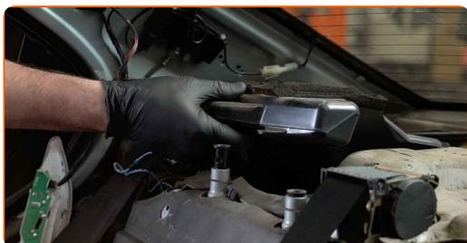
**12** Biege die Innenraum-Schalldämmung nach oben.
