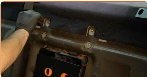
**93** Befestige wieder die Kopfstützenaufnahme des Rücksitzes. Verwenden Sie einen Kreuzschlitzschraubendreher.
