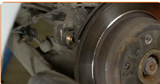
**38** Entfernen Sie die Befestigungsschraube.
