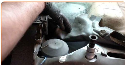
**13** Entfernen Sie die Kappe des Federbeinstützlagers.
