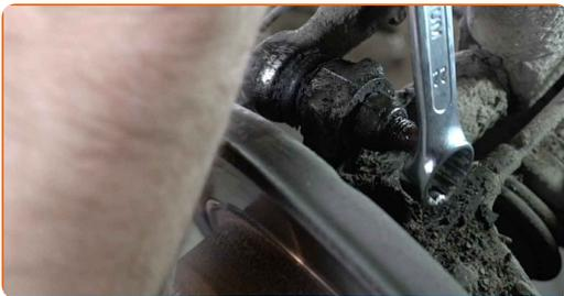
**36** Schrauben Sie die Armbelegung vom Balken ab. Verwenden Sie Ring-Gabelschlüssel Nr. 16.
