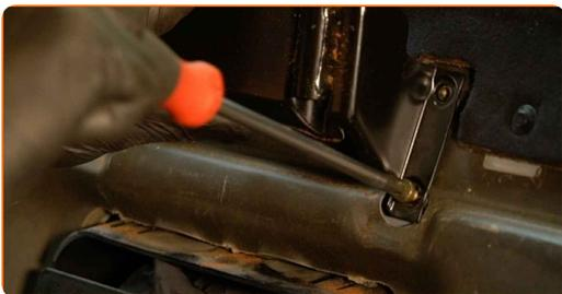
**94** Bringen Sie die Seitenverkleidung aus Kunststoff an. Verwenden Sie einen Zierleistenkeil.
