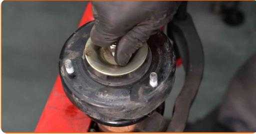
**54** Ziehen Sie die Federbeinkolbenstangenmutter an. Verwenden Sie einen Stoßdämpfer Steckschlüsseinsatz DDN#6. Verwenden Sie Stecknuss Nr. 16. Verwenden Sie einen Drehmomentschlüssel. Ziehen Sie ihn mit 27 Nm Drehmoment fest.
