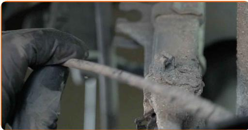
**34** Reinigen Sie alle Verbindungen des Querlenkers. Benutzen Sie eine Drahtbürste. Benutzen Sie WD-40-Spray.
