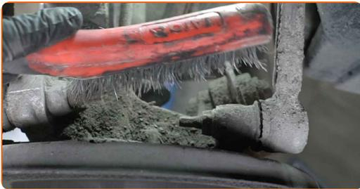
**35** Drehen Sie Befestigungselement auf, das den Querlenker mit dem hinteren Achsschenkel verbindet. Verwenden Sie Ring-Gabelschlüssel Nr. 22. Verwenden Sie Stecknuss Nr. 10. Verwenden Sie einen Ratschenschlüssel.
