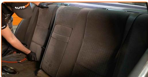
**96** Schraube die Befestigungselemente der Rücksitzlehne ein. Verwenden Sie Stecknuss Nr. 10. Verwenden Sie einen Ratschenschlüssel.
