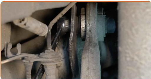
**37** Lösen Sie den unteren Bereich des Federbeins. Benutzen Sie ein Brecheisen.
