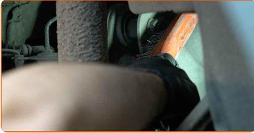
**33** Trennen Sie die ABS Sensorverdrahtung.
