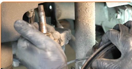
**40** Lösen Sie die obere Befestigung des Domlagers.
