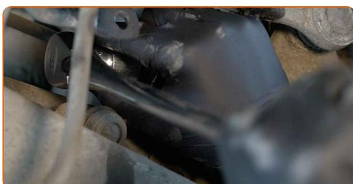
**32** Reinigen Sie alle Verbindungen des Querlenkers. Benutzen Sie eine Drahtbürste. Benutzen Sie WD-40-Spray.
