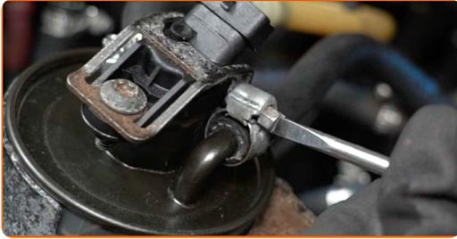
**16** Behandeln Sie den Stecker des Kraftstoffdrucksensors. Verwenden Sie dielektrisches Fett.
