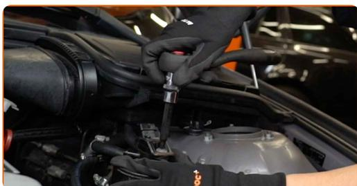
**7** Entfernen Sie den Kraftstoffdrucksensor.
