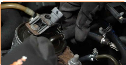
**15** Ziehen Sie die Befestigungsklemme der Kraftstofffilterleitung an. Verwenden Sie einen flachen Schraubendreher.
