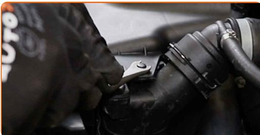
**4** Schrauben Sie die Befestigung des Kühlgebläses ab. Verwenden Sie Ring-Gabelschlüssel Nr. 32 (2 Teile).
