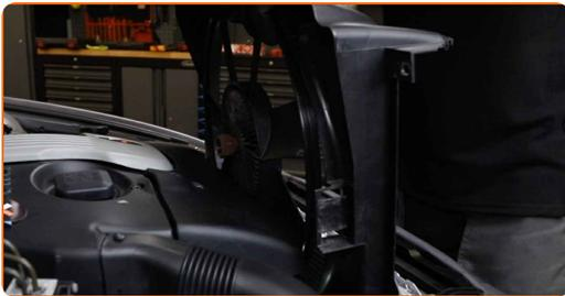
**19** Ziehen Sie die Befestigung des Kühlgebläses an. Verwenden Sie Ring-Gabelschlüssel Nr. 32 (2 Teile). Verwenden Sie einen Drehmomentschlüssel. Ziehen Sie ihn mit 33 Nm Drehmoment fest.
