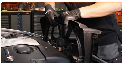
**6** Ziehen Sie die Keilriemenspannrolle beiseite. Verwenden Sie Ring-Gabelschlüssel Nr. 16.
