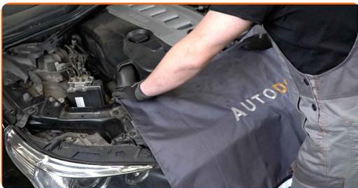
**3** Schrauben Sie die Befestigungen der Abdeckung des Federbeindoms ab. Verwenden Sie einen Kreuzschlitzschraubendreher. Verwenden Sie einen Lösehebel, um die Clips zu entfernen.
