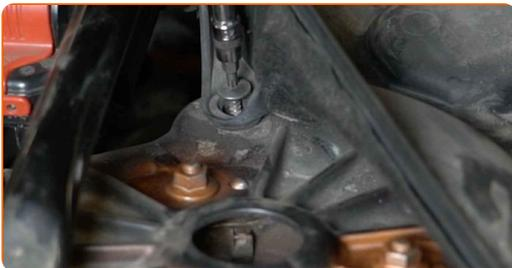
**8** Entfernen Sie den Gehäusedeckel des Innenraumfilters.
