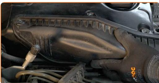
**39** Schrauben Sie das Befestigungselement des Luftansaugrohrs ein. Verwenden Sie Inbusschlüssel Nr. H5. Verwenden Sie einen Ratschenschlüssel.
