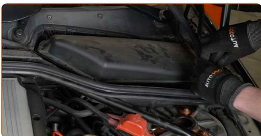
**11** Entfernen Sie den Gehäusedeckel des Innenraumfilters.
