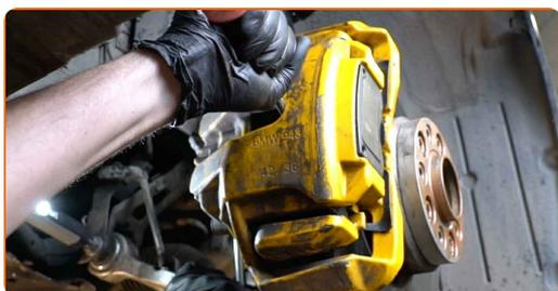
**7** Lösen Sie die Befestigung der Sattelhalterung. Verwenden Sie Stecknuss Nr. 18. Verwenden Sie ein Windeisen.
