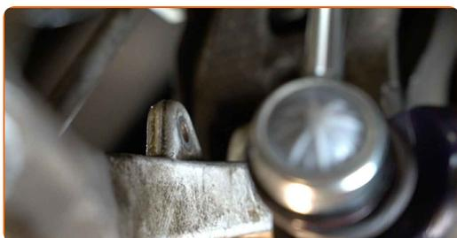
**23** Schrauben Sie das hintere Befestigungselement heraus, das den Querlenker mit dem Hilfsrahmen verbindet. Verwenden Sie Ring-Gabelschlüssel Nr. 18. Verwenden Sie Stecknuss Nr. 18. Verwenden Sie einen Ratschenschlüssel.
