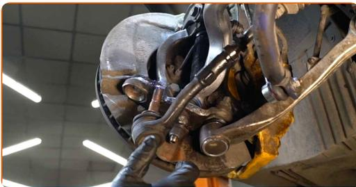
**31** Lösen Sie die hintere Befestigung des Querlenkers.
