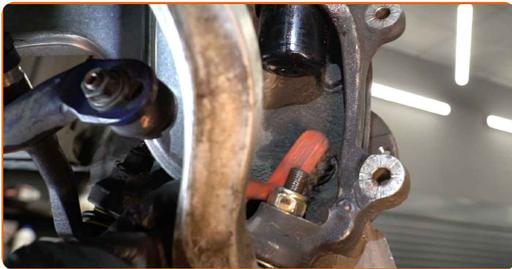
**29** Lösen Sie das Ende der Befestigungsmutter an dem Achsschenkel. Verwenden Sie Stecknuss Nr. 21. Verwenden Sie einen Ratschenschlüssel.
