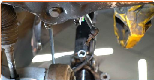
**33** Schrauben Sie die Radnaben-Achsmutter ab. Verwenden Sie Stecknuss Nr. 18. Verwenden Sie einen Ratschenschlüssel.
