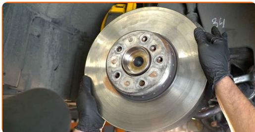
**49** Ziehen Sie die Befestigung der Bremsscheibe fest. Verwenden Sie Inbusschlüssel Nr. H6. Verwenden Sie einen Drehmomentschlüssel. Ziehen Sie ihn mit 16 Nm Drehmoment fest.
