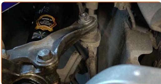
**7** Schrauben Sie das Befestigungselement heraus, das die Druckstange mit dem Stabilisator verbindet. Verwenden Sie Stecknuss Nr. 16. Verwenden Sie einen Ratschenschlüssel.
