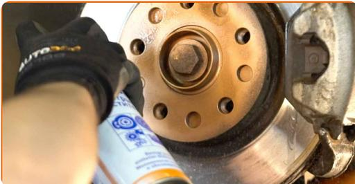
**39** Die Bremsscheibenoberfläche reinigen. Benutzen Sie einen Bremsenreiniger.
