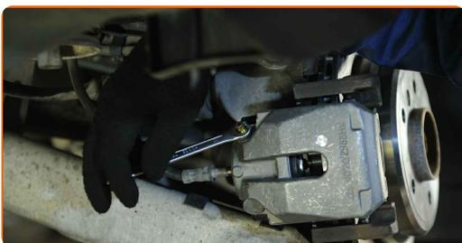
**36** Trennen Sie den Schlauch des Bremsentlüftungs-Kits.
