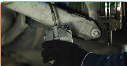
23 Entfernen Sie die Klammer des Bremsschlauchs.
