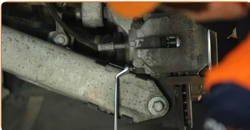
15 Entfernen Sie die Führungstifte aus dem Bremssattel.
