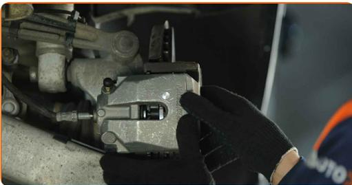
26 Reinigen Sie die Bremssattel-Führungsstifte.
