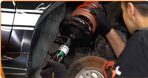
**35** Ziehen Sie die obere Befestigungsmutter des Dämpferbeins heraus. Schrauben Sie diese nicht fest.
