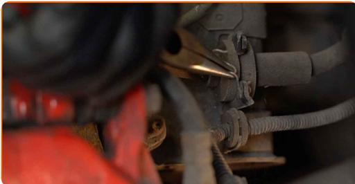
13.1 Reinigen Sie die Befestigungselemente, welche den Stabilenker mit dem Federbein verbinden, sowie die, welche das Federbein mit dem Achsschenkel verbinden.
