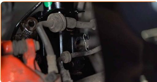
**37** Befestigen Sie das Dämpferbein auf dem Achsschenkel. Die neuen Achsschenkelschrauben einbauen.
