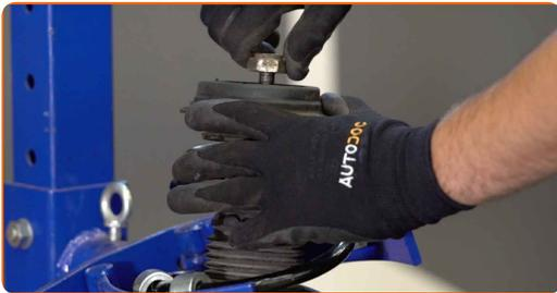
31 Ziehen Sie die Federbeinkolbenstangenmutter an. Benutzen Sie den Ringschlüssel #27. Verwenden Sie Inbusschlüssel Nr. H7. Verwenden Sie einen Drehmomentschlüssel. Ziehen Sie ihn mit 60 Nm Drehmoment fest.
