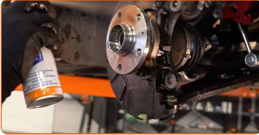
**33** Setzen Sie den Antriebswellenschraube ein und ziehen Sie diese fest. Benutzen Sie eine 12-Kant-Nuss #24.
