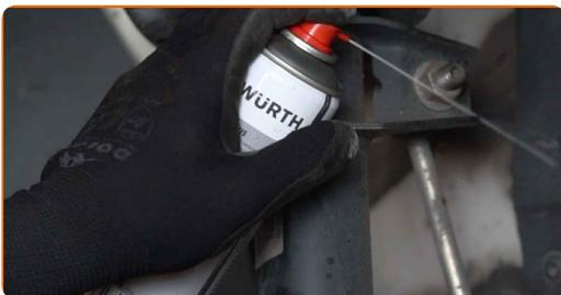
**17** Schrauben Sie die Mutter ab und entfernen Sie die Stabilisatorstange aus dem Federbein. Verwenden Sie Ring-Gabelschlüssel Nr. 16. Benutzen Sie den XZN #6. Verwenden Sie einen Ratschenschlüssel.
