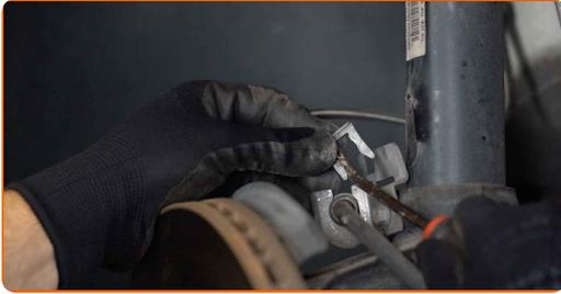
**16** Reinigen Sie die Befestigungselemente, welche den Stabilenker mit dem Federbein verbinden, sowie die, welche das Federbein mit dem Achsschenkel verbinden. Benutzen Sie eine Drahtbürste. Benutzen Sie WD-40-Spray.
