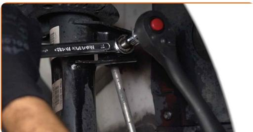
**18** Lösen Sie das Befestigungselement, welches die Antriebswelle mit der Radnabe verbindet. Benutzen Sie eine 12-Kant-Nuss #24.
