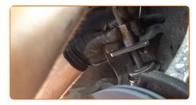
Säubern Sie die Halterung des Bremssattels. Benutzen Sie eine Drahtbürste. Benutzen Sie einen Bremsenreiniger.
