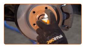
Die Bremsscheibenoberfläche reinigen. Benutzen Sie einen Bremsenreiniger.
