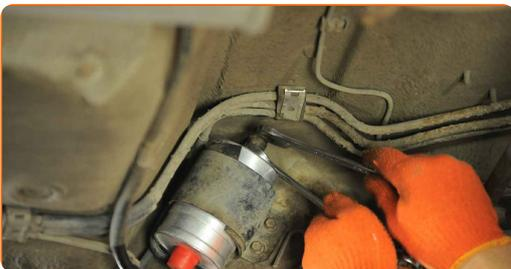
**16** Befestigen Sie die Leitung am Kraftstofffilter.
