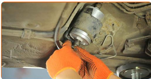
**17** Schrauben Sie das Befestigungselement ein, das die Kraftstoffversorgungsleitung mit dem Kraftstofffiltergehäuse verbindet. Verwenden Sie Ring-Gabelschlüssel Nr. 19. Verwenden Sie Ring-Gabelschlüssel Nr. 22.
