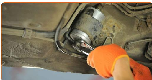
**18** Den Flüssigkeitsbehälter unter dem Kraftstofffilter entfernen.
