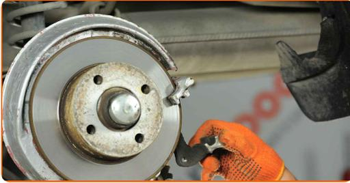
15 Entfernen Sie die Bremsscheibe.
