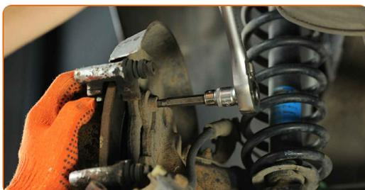
14 Entfernen Sie die Sattelhalterung.
