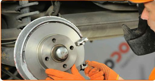
20 Befestigen Sie die Bremssattelhalterung. Verwenden Sie Inbusschlüssel Nr. H8. Verwenden Sie einen Drehmomentschlüssel. Ziehen Sie ihn mit 65 Nm Drehmoment fest.
