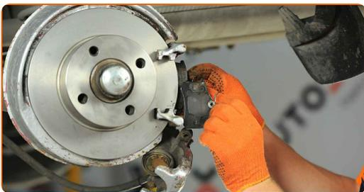
22 Behandeln Sie den Bremssattel-Kolben. Benutzen Sie einen Bremsenreiniger.
