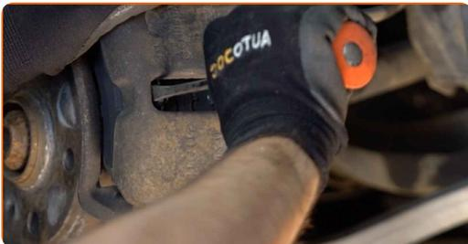
10 Entfernen Sie den Bremssattel.
