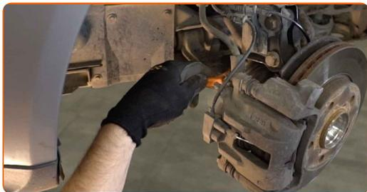
**8** Lösen Sie die Befestigungen, die die ABS-Sensorleitung mit dem Federbein verbinden.
