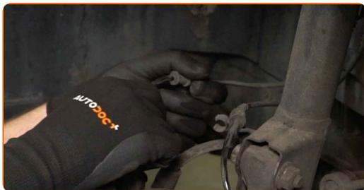
**14** Lösen Sie das Kabel des Bremsbelagverschleißsensors.
