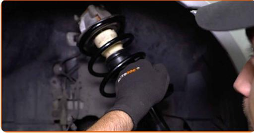
**41** Sichern Sie die oberen Befestigungen des Federbeines. Schrauben Sie diese nicht fest.
