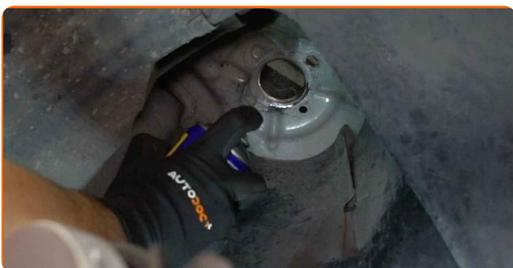
**40** Installieren Sie das Federbein am Radlauf.
