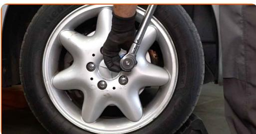
**58** Entfernen Sie den Wagenheber sowie die Unterlegkeile.
