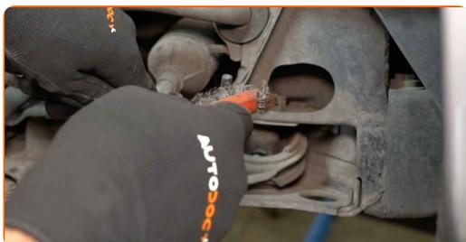
**50** Montieren Sie den Querlenker.
