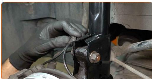
**49** Reinigen Sie die Montagesitze der Koppelstange. Benutzen Sie eine Drahtbürste. Benutzen Sie WD-40-Spray.
