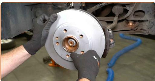
**59** Ziehen Sie die Befestigung der Bremsscheibe fest. Verwenden Sie den Torx T30. Verwenden Sie einen Drehmomentschlüssel. Ziehen Sie ihn mit 9 Nm Drehmoment fest.
