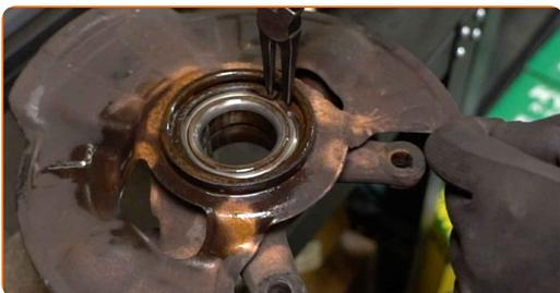
**37** Drücken Sie das Radnabenlager heraus. Verwenden Sie einen Druckstücksatz mit Ein-/Auspresswerkzeug.
