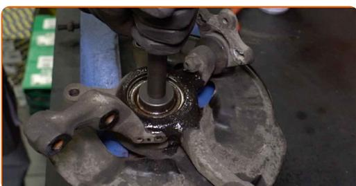
**35** Reinigen Sie den Sicherungsring des Radnabenlagers. Benutzen Sie eine Drahtbürste. Benutzen Sie WD-40-Spray.
