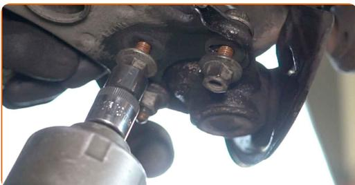
**48** Schrauben Sie die Befestigungen fest, die das Kugelgelenk mit dem Querlenker verbinden. Verwenden Sie Stecknuss Nr. 13. Verwenden Sie einen Drehmomentschlüssel. Ziehen Sie ihn mit 20 Nm Drehmoment fest.+45°
