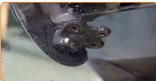
**47** Ziehen Sie das Befestigungselement fest, das das Traggelenk mit dem Achsschenkel verbindet. Verwenden Sie Ring-Gabelschlüssel Nr. 13. Verwenden Sie Stecknuss Nr. 13. Verwenden Sie einen Ratschenschlüssel.
