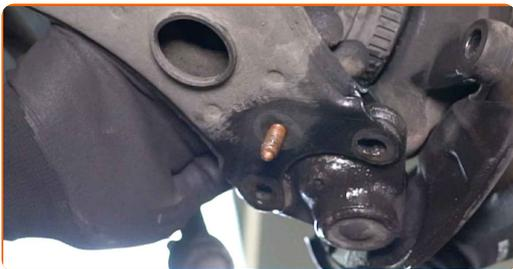
**46** Behandeln Sie den Federbeinbefestigungssitz am Achsschenkel. Benutzen Sie eine Drahtbürste. Benutzen Sie WD-40-Spray.
