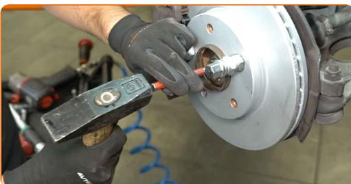
**11** Entfernen Sie die Befestigungsmutter.
