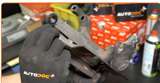
**33** Reinigen Sie den Befestigungssitz der Radnabe. Benutzen Sie eine Drahtbürste. Benutzen Sie WD-40-Spray.
