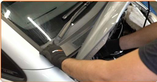
**5** Entfernen Sie die Abdeckungen der Frontscheibenwischerarmmutter.
