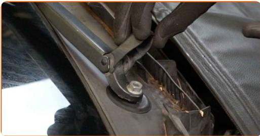
**6** Reinigen Sie die Befestigungen der Wischerarme. Benutzen Sie eine Drahtbürste. Benutzen Sie WD-40-Spray.
