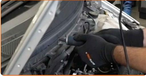
**4** Heben Sie die Windabweiserabdeckung an und entfernen Sie dieses.
