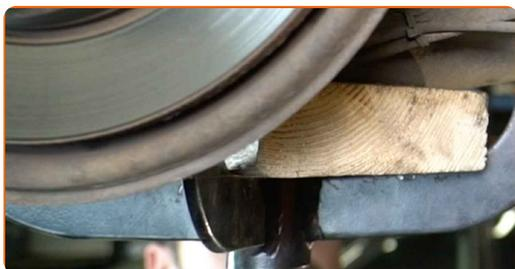
**21** Schrauben Sie das obere Befestigungselement des Stoßdämpfers ein. Verwenden Sie Ring-Gabelschlüssel Nr. 16. Verwenden Sie Stecknuss Nr. 16. Verwenden Sie einen Ratschenschlüssel.
