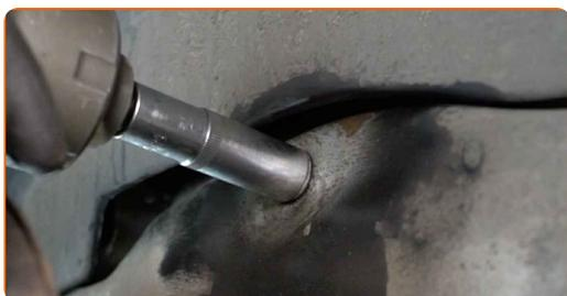
**22** Ziehen Sie die obere Stoßdämpferbefestigung an. Verwenden Sie Stecknuss Nr. 16. Verwenden Sie einen Drehmomentschlüssel. Ziehen Sie ihn mit 40 Nm Drehmoment fest.+90°
