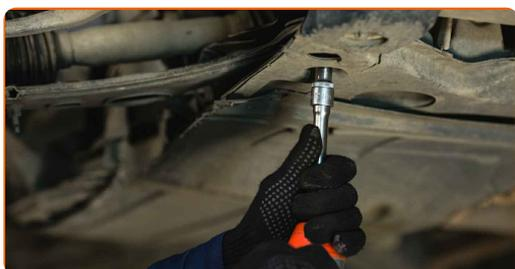
**11** Entfernen Sie die vordere Befestigung des Querlenkers.
