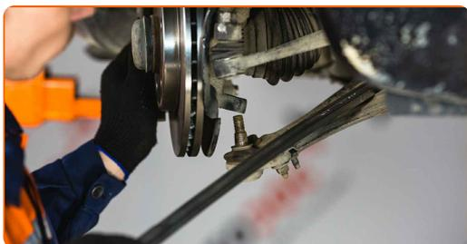
**9** Reinigen Sie die Befestigungselemente, die den Querlenker mit dem Hilfsrahmen verbinden. Benutzen Sie eine Drahtbürste. Benutzen Sie WD-40-Spray.
