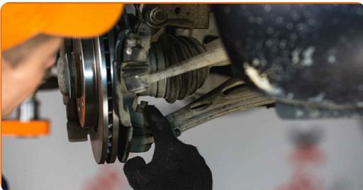
**7** Schrauben Sie die Kugelgelenkbefestigung vom Achsschenkel ab. Verwenden Sie Ring-Gabelschlüssel Nr. 19.
