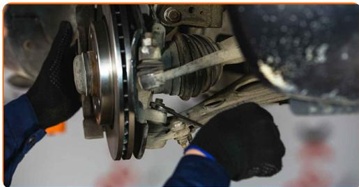
**8** Trennen Sie das Kugelgelenk vom Achsschenkel. Benutzen Sie ein Brecheisen. Benutzen Sie einen Hammer.
