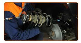
42 Montieren Sie den Querlenker.
