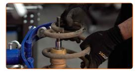
Die Staubkappe des Stoßdämpfers und den Anschlagpuffer entfernen.
