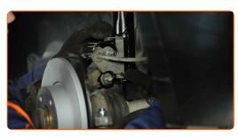
Schrauben Sie das Befestigungselement ein, das das Federbein mit dem Achsschenkel verbindet.
