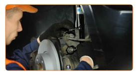
Ziehen Sie die unteren Befestigungen an, die das Federbein mit dem Achsschenkel verbinden. Verwenden Sie Ring-Gabelschlüssel Nr. 21. Verwenden Sie Stecknuss Nr. 21. Verwenden Sie einen Drehmomentschlüssel. Ziehen Sie ihn mit 120 Nm Drehmoment fest.+90°
