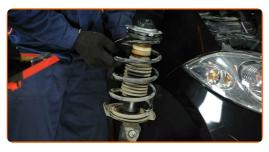
Schrauben Sie das Befestigungselement heraus, das die Druckstange mit dem Federbein verbindet. Verwenden Sie Ring-Gabelschlüssel Nr. 16. Verwenden Sie Inbusschlüssel Nr. H6. Verwenden Sie einen Ratschenschlüssel.
