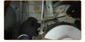
Trennen Sie den Stecker der Verschleißsensoren des Bremsbelags. Benutzen Sie ein Brecheisen.
