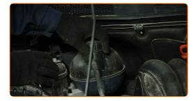
Lösen Sie die obere Befestigung des Domlagers.
