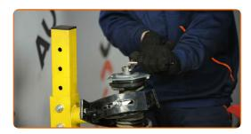
Entfernen Sie das obere Domlager. Benutzen Sie ein Brecheisen.
