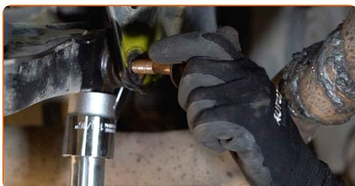
**16** Lösen Sie den Aufhängungsarm vom hinteren Achsschenkel. Benutzen Sie ein Brecheisen.
