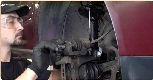
**15** Säubern Sie die Halterung des Bremssattels. Benutzen Sie eine Drahtbürste. Benutzen Sie einen Bremsenreiniger.
