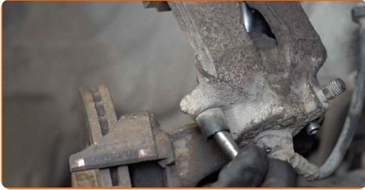
**14** Drücken Sie den Bremssattelkolben rein. Verwenden Sie den Bremskolbenrücksteller.
