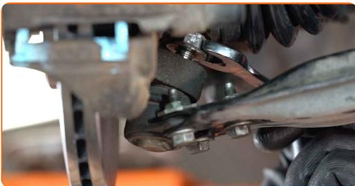
9 Schrauben Sie die vordere Armbefestigung ab. Verwenden Sie Stecknuss Nr. 16.
