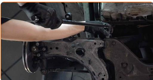
10 Schrauben Sie die hintere Armbefestigung ab. Verwenden Sie Stecknuss Nr. 18.
