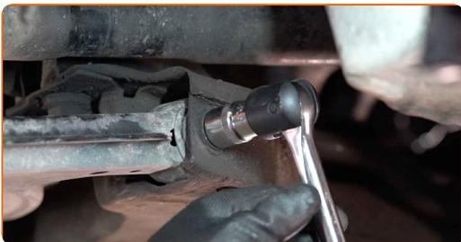
11 Schrauben Sie die Kugelgelenkbefestigung vom Achsschenkel ab.
