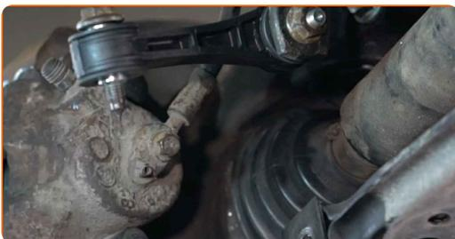
8 Schrauben Sie die Befestigungsmutter des Kugelgelenks ab. Verwenden Sie Ring-Gabelschlüssel Nr. 18.
