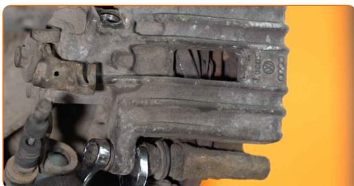
**19** Entfernen Sie den Bremssattel.
