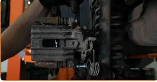
**18** Ziehen Sie die Bremssattelbefestigungen fest. Verwenden Sie Ring-Gabelschlüssel Nr. 15. Verwenden Sie Stecknuss Nr. 13. Verwenden Sie einen Drehmomentschlüssel. Ziehen Sie ihn mit 35 Nm Drehmoment fest.
