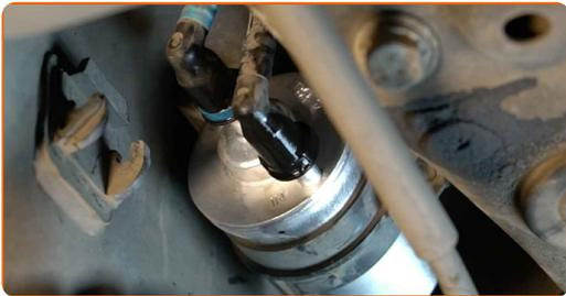
**15** Den Flüssigkeitsbehälter unter dem Kraftstofffilter entfernen.
