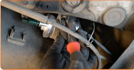
**14** Verbinden Sie die Kraftstoffversorgungsleitungen zum Kraftstofffilter.
