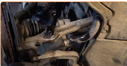
**43** Bringen Sie die Befestigungsschraube an. Verwenden Sie einen Splintentreiber. Benutzen Sie einen Hammer.
