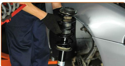
**35** Sichern Sie die oberen Befestigungen des Federbeines.
