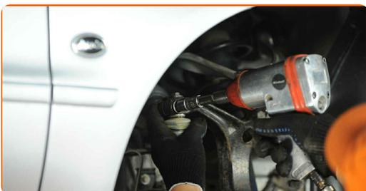
**40** Verbinden Sie den unteren Querlenker mit dem Achsschenkel.
