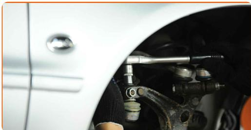
**18.2** Verwenden Sie Stecknuss Nr. 13. Verwenden Sie Stecknuss Nr. 16. Verwenden Sie einen Ratschenschlüssel.
