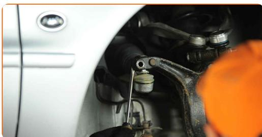
**21** Schrauben Sie die Befestigungen des unteren Arms ab. Verwenden Sie Ring-Gabelschlüssel Nr. 17. Verwenden Sie Stecknuss Nr. 17. Verwenden Sie einen Ratschenschlüssel.
