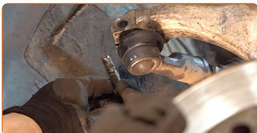
**20** Ziehen Sie den Spurstangenkopf vom Achsschenkel. Verwenden Sie einen flachen Metallmeißel. Benutzen Sie einen Hammer.
