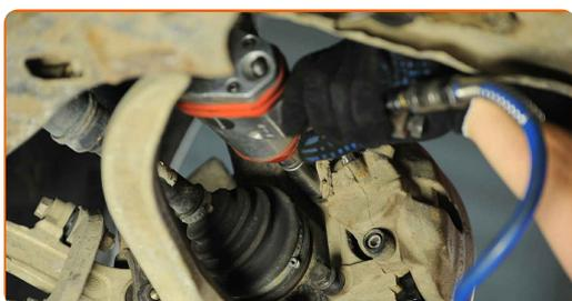
**8** Entfernen Sie die Befestigungsschrauben (2 Stück).
