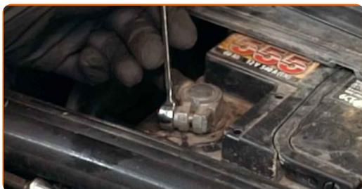
**20** Entfernen Sie die Batterieklemmen.
