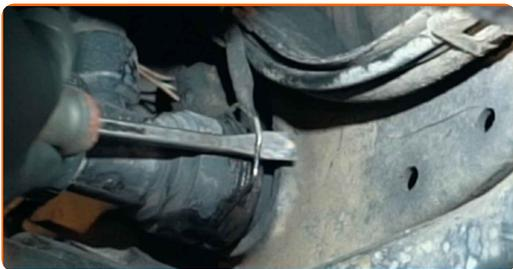
**9** Lösen Sie den Kühlmittelschlauch.
