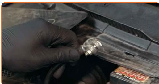
**21** Lockern Sie die Befestigungen der Lichtmaschine. Verwenden Sie Inbusschlüssel Nr. H8.
