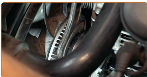
**23** Lockern Sie die Befestigungen der Lichtmaschine. Verwenden Sie Inbusschlüssel Nr. H8.
