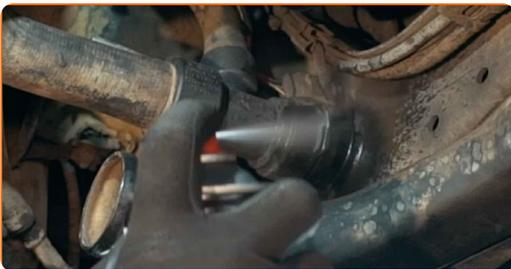
**8** Trennen Sie die Halteklammer der Kühlmittleitung.
