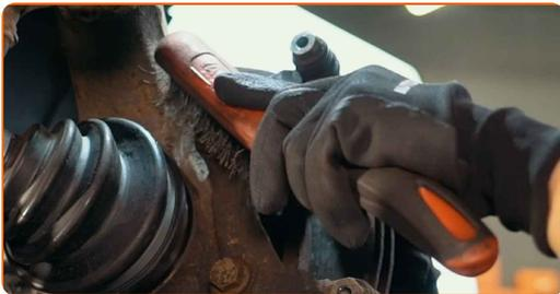
**14** Lösen Sie die Befestigung der Sattelhalterung. Verwenden Sie Stecknuss Nr. 17. Verwenden Sie einen Ratschenschlüssel. Verwenden Sie ein Windeisen.
