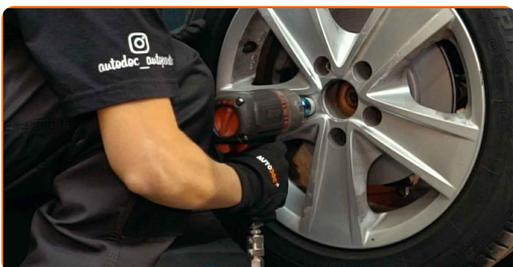
**33** Senken Sie das Auto und ziehen Sie die Radschrauben über Kreuz an. Verwenden Sie eine Schlagnuss für Felgen # 17. Verwenden Sie einen Drehmomentschlüssel. Ziehen Sie ihn mit 120 Nm Drehmoment fest.
