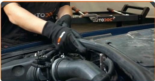
**4** Schrauben Sie die Befestigung der Windlaufabdeckung auf. Verwenden Sie den Torx T20. Verwenden Sie einen flachen Schraubendreher.
