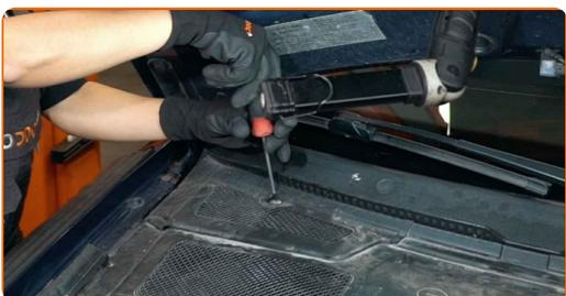
**5** Heben Sie die Windabweiserabdeckung an und entfernen Sie dieses.
