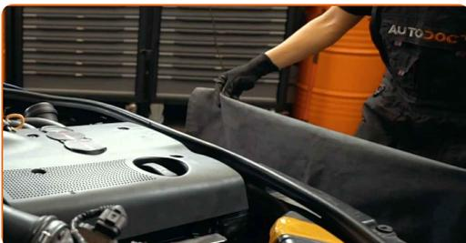
**3** Entfernen Sie die Dichtung der Windabweiserabdeckung.
