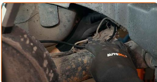
**31** Reinigen Sie den Achsschenkel. Benutzen Sie einen Bremsenreiniger.
