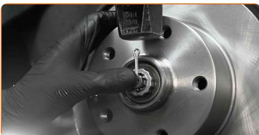
**36** Installieren Sie die Kappe der Nabenmutter. Verwenden Sie einen Gummi-Hammer.
