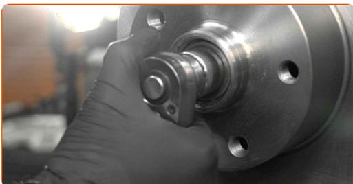
**35** Sichern Sie die Nabenmutter mit einem neuen Splint. Benutzen Sie einen Hammer. Benutzen Sie ein Brecheisen.
