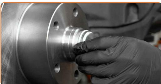
**37** Entfernen Sie Schmutz und Staub vom Bremssattelhalter. Benutzen Sie eine Drahtbürste. Benutzen Sie einen Bremsenreiniger.
