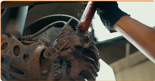
**10** Schrauben Sie die Befestigung des Bremssattels ab. Verwenden Sie Ring-Gabelschlüssel Nr. 13. Verwenden Sie Ring-Gabelschlüssel Nr. 15. Verwenden Sie einen Ratschenschlüssel.
