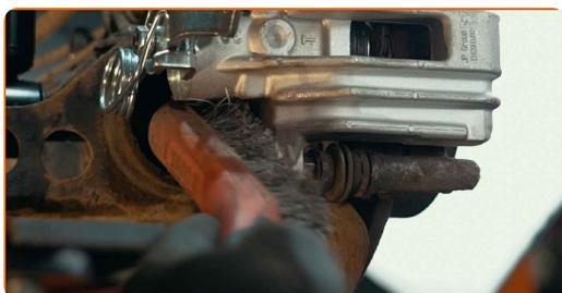
**7** Schrauben Sie die Befestigung des Bremssattels ab. Verwenden Sie Ring-Gabelschlüssel Nr. 15. Verwenden Sie Stecknuss Nr. 13. Verwenden Sie einen Ratschenschlüssel.
