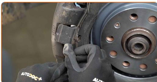
**23** Verbinden Sie den Bremsbelag-Verschleiß-Sensor.
