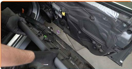
**15** Lösen Sie den Steckverbinder des elektrischen Fensterhebers vom Türblech.
