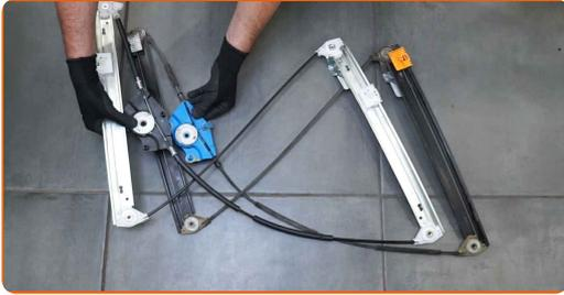
**38** Schrauben Sie die Befestigungen des Ritzels des Fensterhebers ein. Verwenden Sie den Torx T25. Verwenden Sie einen Ratschenschlüssel.
