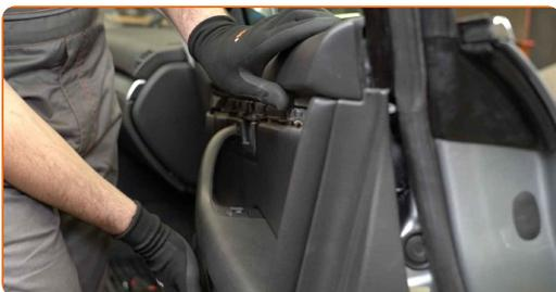
**67** Schrauben Sie die oberen Befestigungen der Türverkleidung ein. Verwenden Sie einen Kreuzschlitzschraubendreher.
