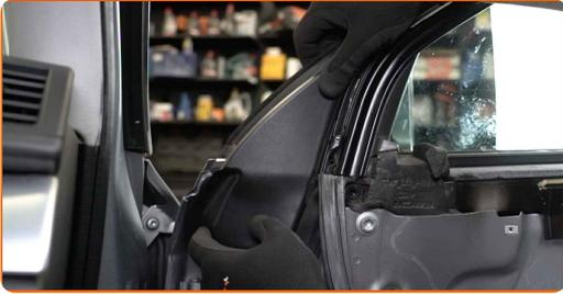
**50** Schrauben Sie die Befestigungen des Fensterrahmens ein. Verwenden Sie den Torx T45. Verwenden Sie einen Ratschenschlüssel.
