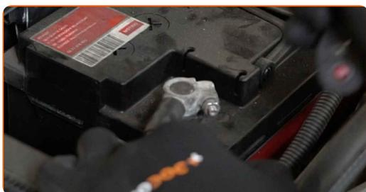
**4** Entfernen Sie die Batterieklemmen.
