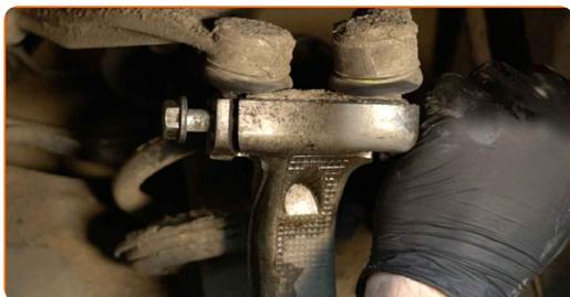
**29** Trennen Sie den oberen Querlenker vom Achsschenkel. Benutzen Sie ein Brecheisen.
