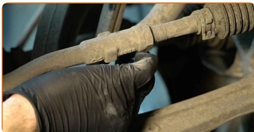
**19** Reinigen Sie die Federbein-Befestigungselemente. Benutzen Sie eine Drahtbürste. Benutzen Sie WD-40-Spray.
