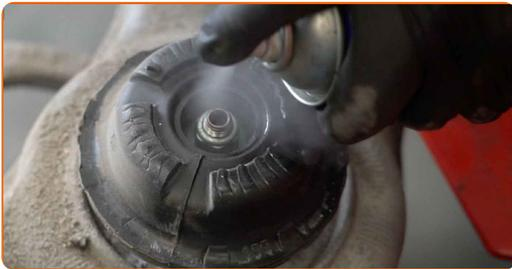
**51** Entfernen Sie die Stangenmutter des Federkolben. Verwenden Sie Stecknuss Nr. 18. Verwenden Sie Inbusschlüssel Nr. H6. Verwenden Sie einen Ratschenschlüssel.
