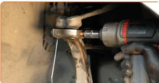
**81** Schrauben Sie die Befestigungsmutter auf, die den Spurstangenkopf mit dem Achsschenkel verbindet. Verwenden Sie Ring-Gabelschlüssel Nr. 21.
