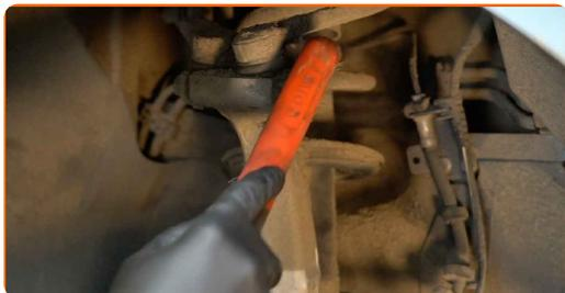
**13** Schrauben Sie die oberen Steuerarmverschlüsse ab (2 Stück). Verwenden Sie Ring-Gabelschlüssel Nr. 16. Verwenden Sie Stecknuss Nr. 16. Verwenden Sie einen Ratschenschlüssel.
