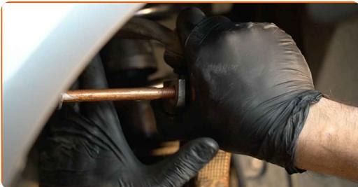
**80** Drehe die Schrauben (2 Stück) des oberen Querlenkers ein. Verwenden Sie Ring-Gabelschlüssel Nr. 16. Verwenden Sie Stecknuss Nr. 16. Verwenden Sie einen Ratschenschlüssel.
