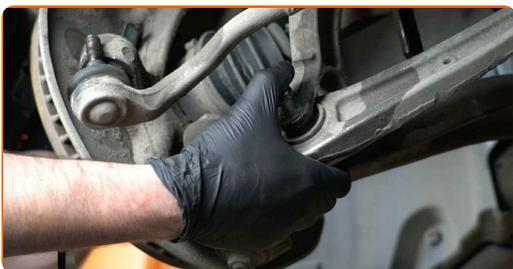
**42** Lösen Sie die obere Befestigung des Domlagers.
