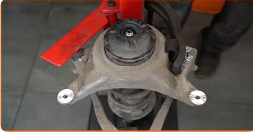
**50** Behandeln Sie die Federbeinstange. Benutzen Sie eine Drahtbürste. Benutzen Sie WD-40-Spray.
