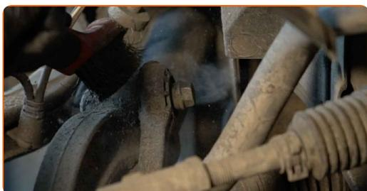
**15** Schrauben Sie die Befestigungsmutter heraus, die die Koppelstange an der Stoßdämpfergabel befestigt. Verwenden Sie Ring-Gabelschlüssel Nr. 16.
