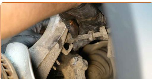
**83** Verbinden Sie das ABS mit der Sensorverdrahtung.
