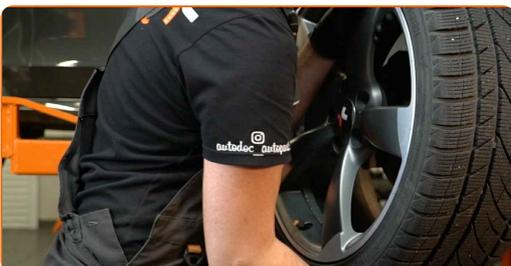
**12** Reinigen Sie alle Verbindungen des Querlenkers. Benutzen Sie eine Drahtbürste. Benutzen Sie WD-40-Spray.
