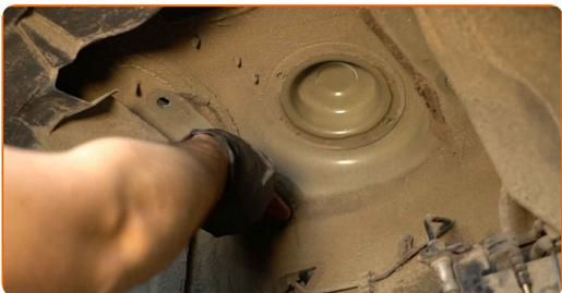
**69** Löse den Schraubstock und entnehme das mit den Querlenkern verbundene Federbein.
