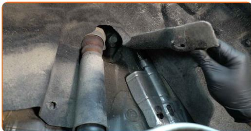
**9** Reinigen Sie die Stoßdämpferbefestigungen. Benutzen Sie eine Drahtbürste. Benutzen Sie WD-40-Spray.
