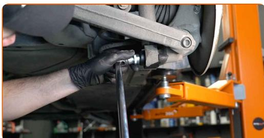
**11** Entfernen Sie die Befestigungsschraube.
