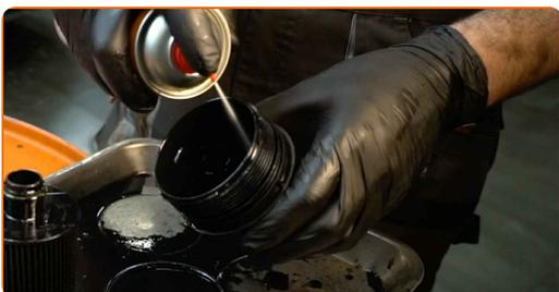
**18** Installieren Sie einen neuen Dichtungsring an seinem Montagesitz auf der Filterabdeckung.
