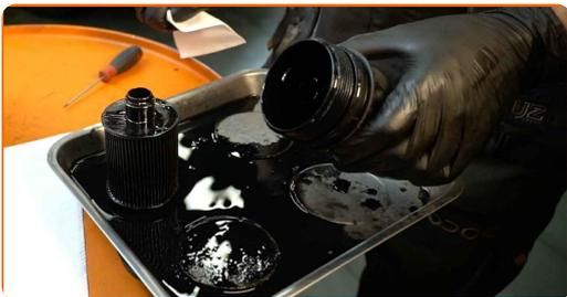
**16** Den Dichtungsring des Ölfilterdeckels entfernen. Verwenden Sie einen flachen Schraubendreher.
