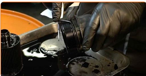
**17** Reinigen Sie den Deckel des Ölfilter-Gehäuses. Verwenden Sie Allzweckreinigungspray.
