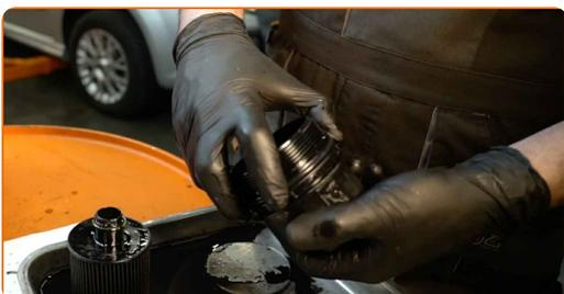
**19** Setzen Sie den neuen Ölfilter in den Montagesitz auf der Filterabdeckung ein.
