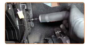
Entfernen Sie den Gehäusedeckel des Innenraumfilters.
