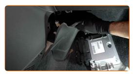
Schrauben Sie die Verbindungselemente der Innenfilter-Gehäuseabdeckung ab. Verwenden Sie einen Kreuzschlitzschraubendreher. Verwenden Sie einen Ratschenschlüssel.
