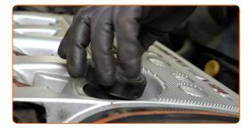
Entfernen Sie die Öleinfüllschraube.
