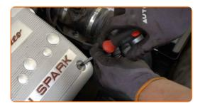
Schrauben Sie die Öleinfüllschraube ab.
