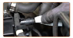
Lösen Sie den Steckverbinder des Luftmassenmessers.
