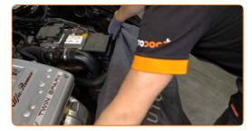
Schrauben Sie den Deckel des Kühlmittelbehälters ab.
