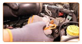
Verbinden Sie das Luftansaugrohr mit dem Luftfilter-Gehäuse.
