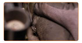
Lösen Sie den Kühlmittelschlauch.
