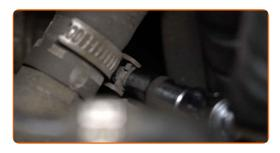
Lösen Sie den Kühlmittelschlauch.
