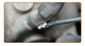
Lösen Sie den Kühlmittelschlauch.
