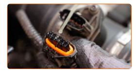
Bringen Sie den Steckverbinder des Luftmassenmessers an.
