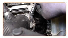
Trennen Sie das Luftansaugrohr vom Luftfilter-Gehäuse.
