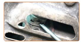
Lösen Sie den Kühlmittelschlauch.
