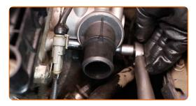
Bringen Sie den Kühlmittelschlauch an.
