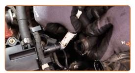
Verbinden Sie auf der rechten Seite den Schlauch des PCV-Ventils mit der Motorabdeckung. Verwenden Sie eine Clic-R-Kragenzange.
