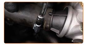
Behandeln Sie den Stecker des Kühlmitteltemperatursensor. Verwenden Sie dielektrisches Fett.
