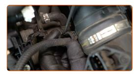
Schrauben Sie die Halteklammer und Befestigungen am Ansaugrohr des Luftfilters ab. Verwenden Sie Stecknuss Nr. 7. Verwenden Sie einen Ratschenschlüssel.
