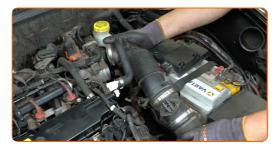
Bedecken Sie die Drosselklappe mit einem Mikrofasertuch, um zu vermeiden, dass Staub und Schmutz in das System gelangen.
