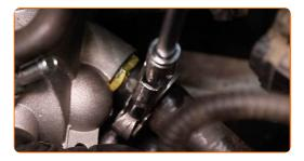
Bringen Sie den Kühlmittelschlauch an.
