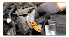
Entfernen Sie das Filterelement aus dem Filtergehäuse.
