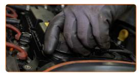
Lösen Sie auf der rechten Seite den Schlauch des PCV-Ventils von der Motorabdeckung. Verwenden Sie einen flachen Schraubendreher.
