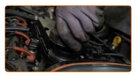
Befestigen Sie den Deckel des Öleinfüllstutzens.
