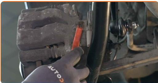
**9** Schrauben Sie die Befestigung des Bremssattels ab. Verwenden Sie Ring-Gabelschlüssel Nr. 13.
