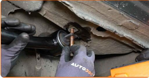
**15** Schrauben Sie das hintere Befestigungselement ein, das den Querlenker mit der Karosserie verbindet. Verwenden Sie Stecknuss Nr. 15. Verwenden Sie einen Ratschenschlüssel.
