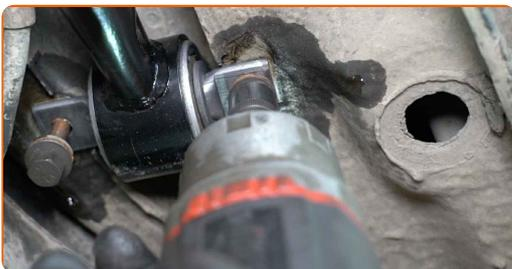
**16** Stützen Sie den Arm. Benutzen Sie einen hydraulischen Getriebeheber.
