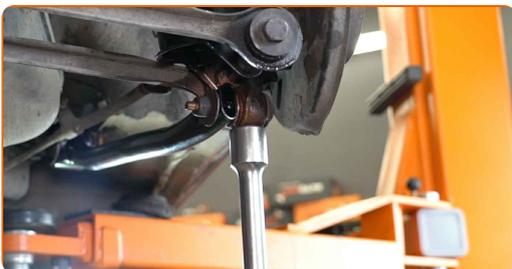
**17** Schrauben Sie die hinteren Befestigungen, welche den Querlenker mit der Fahrzeugkarosserie verbinden, fest. Verwenden Sie Stecknuss Nr. 15. Verwenden Sie einen Drehmomentschlüssel. Ziehen Sie ihn mit 68 Nm Drehmoment fest.
