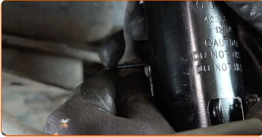
**62** Behandeln Sie die Federbein-Befestigungen. Behandeln Sie alle Gelenke der Koppelstange. Behandeln Sie die Befestigungen des hinteren Achsschenkels. Benutzen Sie ein Kupferschmiermittel.
