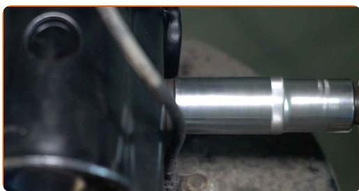
**52** Ziehen Sie das Befestigungselement an, das den Achslenker mit dem Achsschenkel verbindet. Verwenden Sie Ring-Gabelschlüssel Nr. 19. Verwenden Sie Stecknuss Nr. 19. Verwenden Sie einen Drehmomentschlüssel. Ziehen Sie ihn mit 115 Nm Drehmoment fest.
