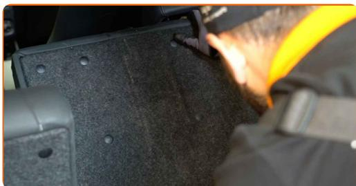
**5** Schrauben Sie das Befestigungselement der zentralen Schutzverkleidung aus Kunststoff heraus. Verwenden Sie einen Kreuzschlitzschraubendreher.
