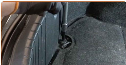
**7** Entfernen Sie die zentrale Schutzverkleidung aus Kunststoff.
