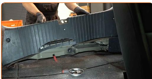
**8** Entfernen Sie die Kofferraumverkleidung.
