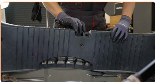
**80** Schrauben Sie das Befestigungselement der zentralen Schutzverkleidung aus Kunststoff ein. Verwenden Sie einen Kreuzschlitzschraubendreher.
