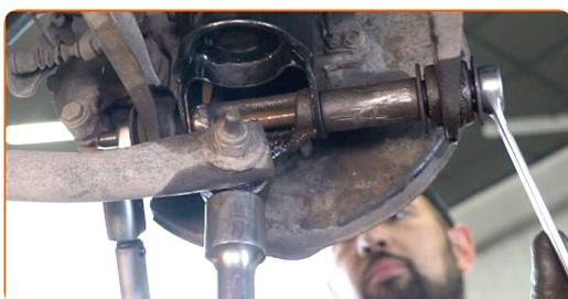
**53** Ziehen Sie die Befestigung, die das Federbein mit dem hinteren Achsschenkel verbindet, fest. Verwenden Sie Ring-Gabelschlüssel Nr. 19. Verwenden Sie Stecknuss Nr. 19. Verwenden Sie einen Drehmomentschlüssel. Ziehen Sie ihn mit 115 Nm Drehmoment fest.
