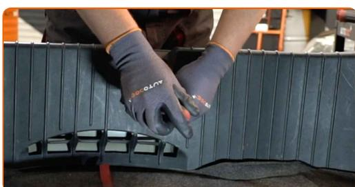
**6** Lösen Sie die Haken, die die Kofferraumverkleidung festhalten. Verwenden Sie Inbusschlüssel Nr. H5. Verwenden Sie einen Ratschenschlüssel.
