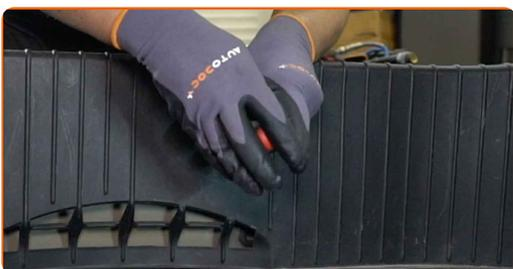
**81** Ziehen Sie die Haken fest, die die Kofferraumverkleidung festhalten. Verwenden Sie Inbusschlüssel Nr. H5. Verwenden Sie einen Ratschenschlüssel.
