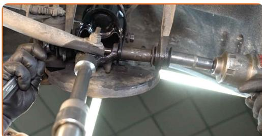
**51** Schrauben Sie die Befestigung an, die den Stoßdämpfer mit dem hinteren Achsschenkel verbindet. Verwenden Sie Ring-Gabelschlüssel Nr. 19. Verwenden Sie Stecknuss Nr. 19. Verwenden Sie einen Ratschenschlüssel.
