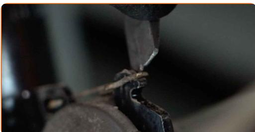
**61** Verbinden Sie das ABS mit der Sensorverdrahtung.
