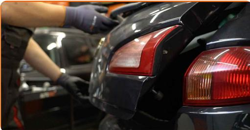
**3** Bewegen Sie das Faltregal und lösen Sie es von den Halterungen. Auf diese Weise erlangen Sie Zugang zu den Kunststoffplatten der Außenverkleidung.
