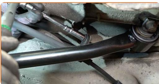
**23** Reinigen Sie die Befestigung des Handbremsseils. Benutzen Sie eine Drahtbürste. Verwenden Sie Allzweckreinigungsspray.
