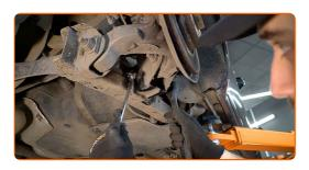
Entfernen Sie die Befestigungsschraube.
