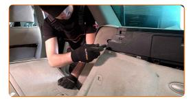
Entfernen Sie die Seitenauskleidung des Kofferraums.
