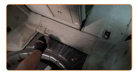
8 Entfernen Sie die untere Auskleidung des vorderen Kofferraumbereichs.
