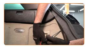
Entfernen Sie die zentrale Schutzverkleidung aus Kunststoff.
