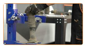
Entnehmen Sie den alten Stoßdämpfer aus dem hydraulischen Spiralfederspanner.
