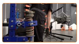
Entfernen Sie die Stangenmutter des Federkolben. Verwenden Sie Ring-Gabelschlüssel Nr. 17. Verwenden Sie Stecknuss Nr. 8. Verwenden Sie einen Ratschenschlüssel.
