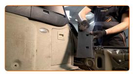
Entfernen Sie die Abdeckung der Seitenauskleidung des Kofferraums.
