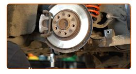
Ziehen Sie das hintere Befestigungselement an, das den hinteren Achsschenkel mit dem Querlenker der Aufhängung verbindet. Verwenden Sie Ring-Gabelschlüssel Nr. 22. Verwenden Sie einen Drehmomentschlüssel. Ziehen Sie ihn mit 105 Nm Drehmoment fest.+45°
