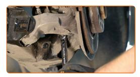
Entfernen Sie die Befestigungsschraube.
