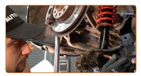
Reinigen Sie die Montagesitze des hinteren Achsschenkels. Benutzen Sie eine Drahtbürste. Benutzen Sie WD-40-Spray.
