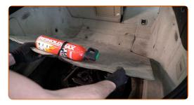
Entfernen Sie die Clips der unteren Auskleidung des vorderen Kofferraumbereichs. Verwenden Sie einen Lösehebel, um die Clips zu entfernen.
