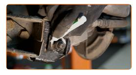
Schrauben Sie das hintere Befestigungselement heraus, das den hinteren Achsschenkel mit dem Querlenker der Aufhängung verbindet. Verwenden Sie Ring-Gabelschlüssel Nr. 22.
