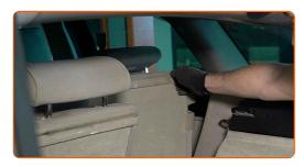
6 Heben Sie die untere Kofferraumverkleidung an.
