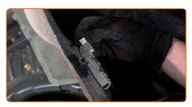
Schrauben Sie das Befestigungselement heraus und entfernen Sie die Schalldämmung an der Kofferraumseite.
