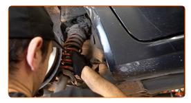
Stellen Sie das Dämpferbein auf das Federspannwerkzeug.
