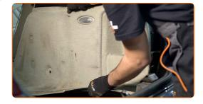
Entfernen Sie die Sicherheitsgurt-Verkleidung. Verwenden Sie Stecknuss Nr. 10. Verwenden Sie einen Ratschenschlüssel.
