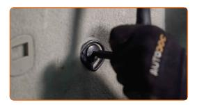
Bringen Sie die Abdeckung der Seitenauskleidung des Kofferraums an.
