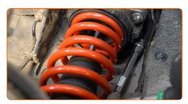
Ziehen Sie das Befestigungselement an, das den Stabilisator mit dem Querlenker verbindet. Verwenden Sie Ring-Gabelschlüssel Nr. 18. Verwenden Sie Stecknuss Nr. 18. Verwenden Sie einen Drehmomentschlüssel. Ziehen Sie ihn mit 55 Nm Drehmoment fest.
