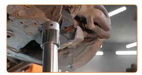
Schrauben Sie das hintere Befestigungselement ein, das den hinteren Achsschenkel mit dem Querlenker der Aufhängung verbindet. Verwenden Sie Ring-Gabelschlüssel Nr. 22.
