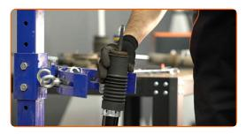
Installieren Sie die Feder am Stoßdämpfer.
