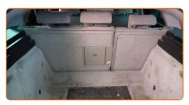
98 Setzen Sie die untere Kofferraumverkleidung ab.
