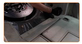
Bringen Sie die Clips der unteren Auskleidung des vorderen Kofferraumbereichs an.
