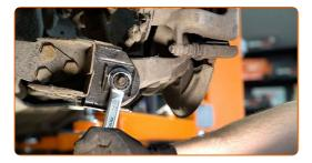
Entfernen Sie die Befestigungsschraube. Benutzen Sie ein Brecheisen. Verwenden Sie einen Gummi-Hammer.
