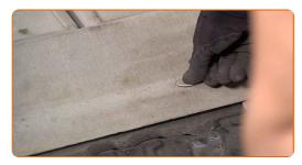
Bringen Sie die Sicherheitsgurt-Verkleidung an. Verwenden Sie Stecknuss Nr. 10.
