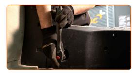
Schrauben Sie die Befestigungen der Kunststoffplatten der Seitenverkleidung heraus. Verwenden Sie einen Kreuzschlitzschraubendreher.
