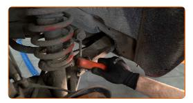
Schrauben Sie das Befestigungselement heraus, das den Stabilisator mit dem Querlenker verbindet. Verwenden Sie Stecknuss Nr. 18.
