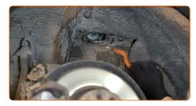
60 Installieren Sie das Federbein am Radlauf.
