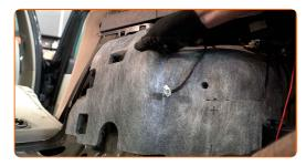
Reinigen Sie die Befestigungselemente des Stoßdämpferdomlagers. Benutzen Sie WD-40-Spray.
