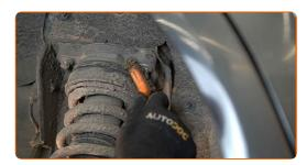
Lösen Sie die obere Befestigung des Domlagers. Verwenden Sie Stecknuss Nr. E14. Verwenden Sie einen Ratschenschlüssel.
