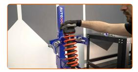
Reinigen Sie die Anbringungssitze des Federbeins. Benutzen Sie eine Drahtbürste. Benutzen Sie WD-40-Spray.
